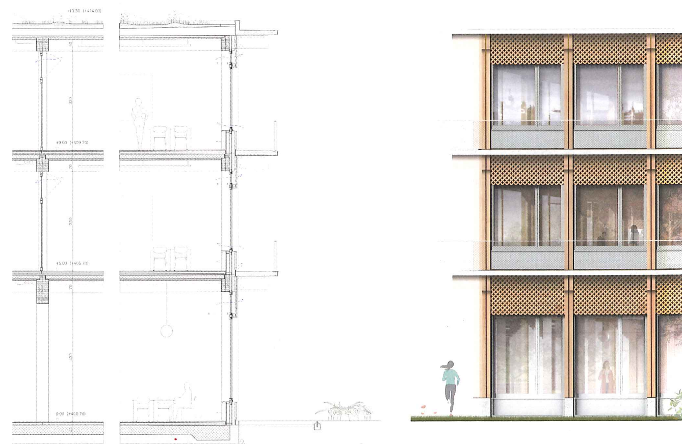
« Rose des vents ». Coupe constructive et élévation du lauréat du concours pour le gymnase du Chablais. (GIORGIS RODRIGUEZ ARCHITECTES)
